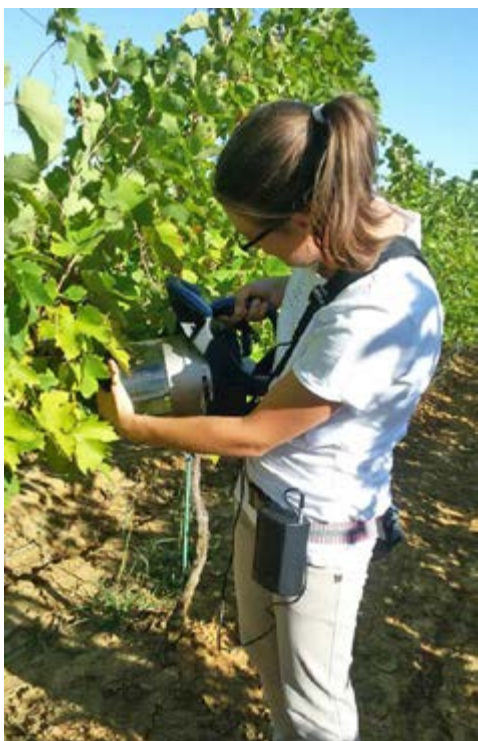
Verifica della maturazione dei grappoli con uno strumento per valutare il contenuto di polifenoli in un vigneto sperimentale di Horta
